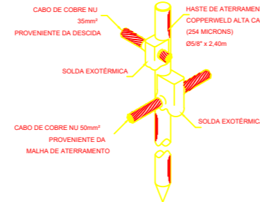
7 DET. - HASTE DE ATERRAMENTO SEM ESCALA
